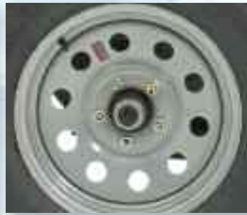
Engrasador para cojinetes de rueda Ofrece una conveniente lubricación de los cojinetes de la rueda gracias a los accesorios de engrase.
